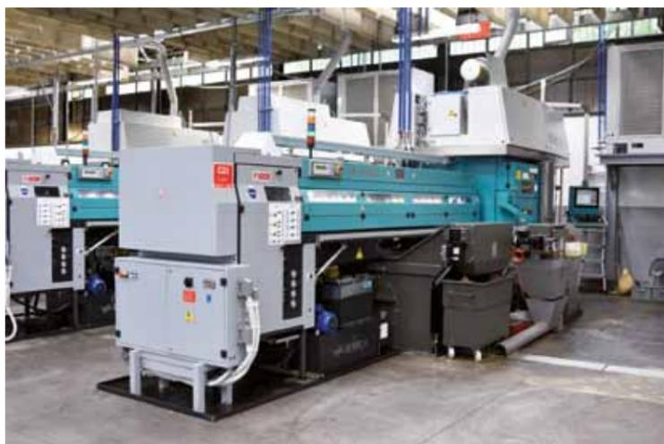
Tutti i torni Index installati in Aignep sono dotati di caricatore automatico di barre
